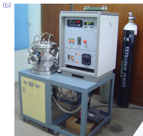
ภาพที่ 1 เครื่องเคลือบสุญญากาศระบบดีซีรีแอคทีฟแมกนีตรอนสปัตเตอริง (a) ไดอะแกรมของเครื่องเคลือบ และ (b) เครื่องเคลือบที่ใช้ในงานวิจัยจริง
